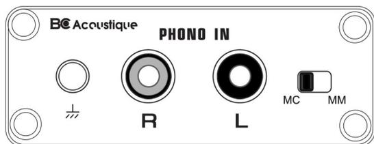
Note : En fonction de la cellule de votre platine vinyle, positionnez le sélecteur MM (aimant mobile) ou MC (bobine mobile).
